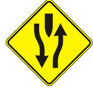
Calzada Dividida P 20
