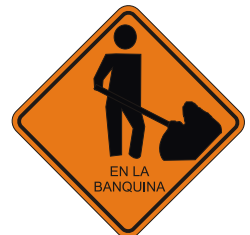
Trabajos en la Banquina T 8
