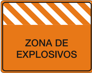
Zona de Explosivos T 9
